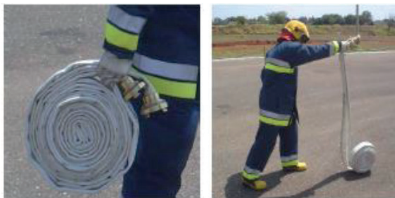
Figura 39: Forma de desenrolar a mangueira aduchada pelo meio de 1½ Polegadas
