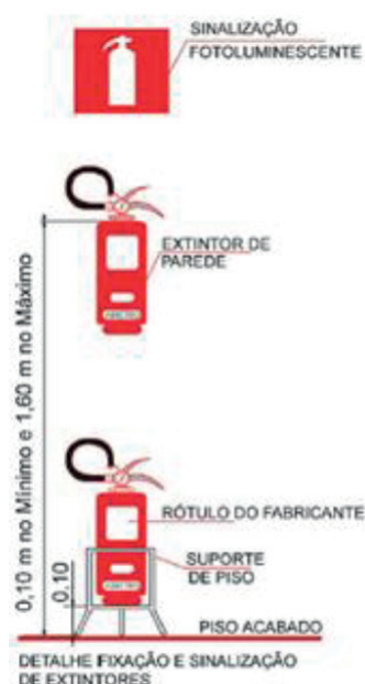
Figura 28: Fixação de Extintores
